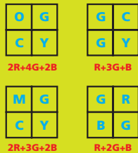
Obr. 14. Některé kombinace aditivních a subtraktivních filtrů (O - bez filtru) a výsledné hodnoty jimi získaného signálu.
